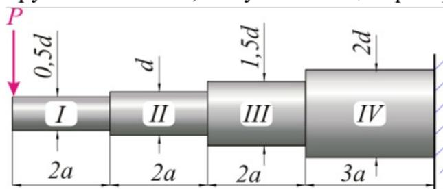
6 Применяя общеинженерные знания решите производственную задачу (ОПК-5.3). Определите напряженное состояние выделенного элемента балки.
