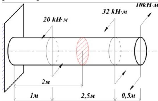
3 Применяя общеинженерные знания решите производственную задачу (ОПК-5.3). Определить в какой из точек круглого сплошного поперечного сечения при чистом кручении данного бруса, касательные напряжения будут по модулю максимальны...
